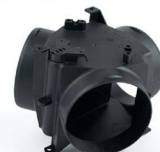
TRÓJNIK W KSZTAŁCIE Y REGULOWANY 90X90X90 (wymagane ciągnie 75714) z wylotami 45° po obu stronach, regulo- wany przez linkę Bowdena Nr artykułu 69033
