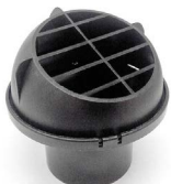
WYLOT POWIETRZA 60MM średnica zew. Ø 95mm obrotowy 360°, nachylenie pod kątem 45° Nr artykułu 69016
