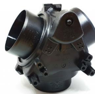
TRÓJNIK W KSZTAŁCIE Y REGULOWANY 60X60X60 (wymagane ciągnie nr 75714) z wylotami 45° po obu stronach, regulowany przez linkę Bowdena Nr artykułu 72517
